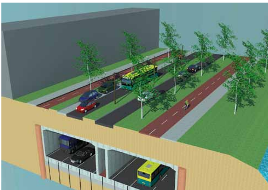
Tunneldoorsnede ter hoogte van de Vijf Meilaan
